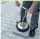
zum Verlegen, von glatten (glasiert) nicht porösen Platten bis 25 kg
