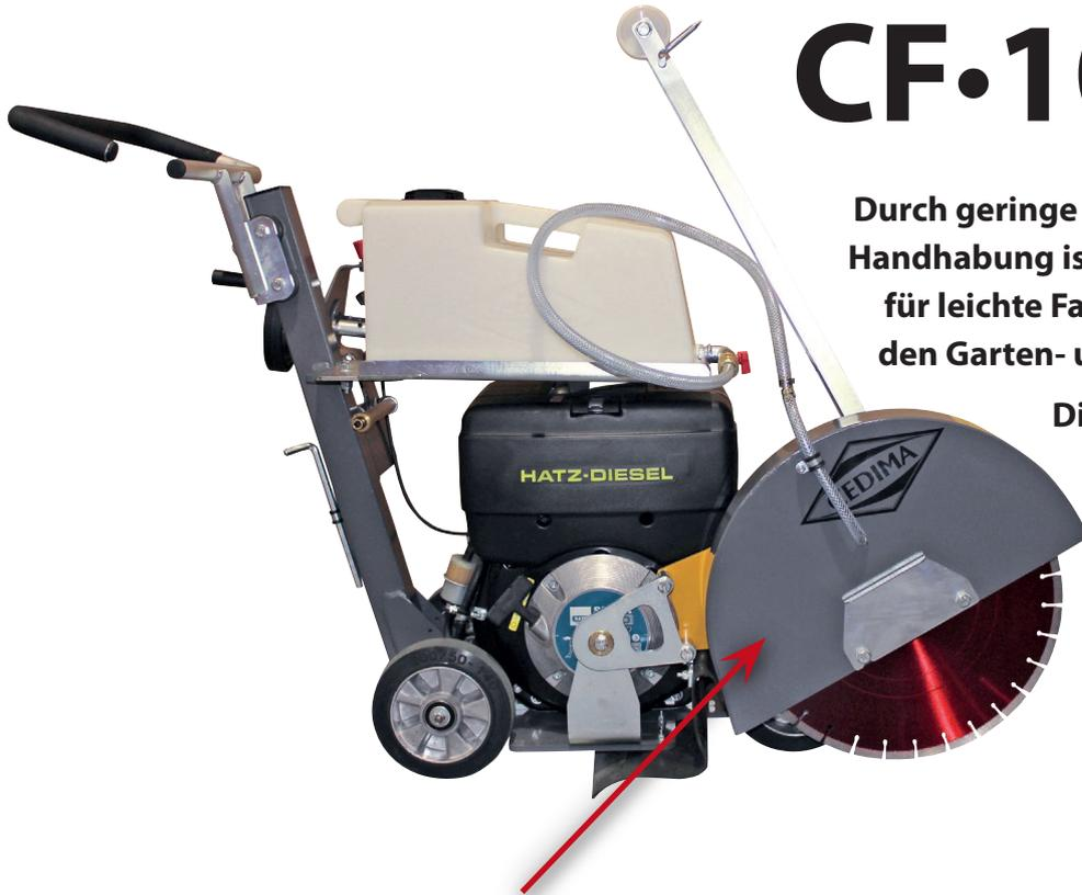
Durch geringe Abmessungen und einfachste Handhabung ist der Fugenschneider optimal für leichte Fahrbahnsanierungen sowie für den Garten- und Landschaftsbau geeignet.
