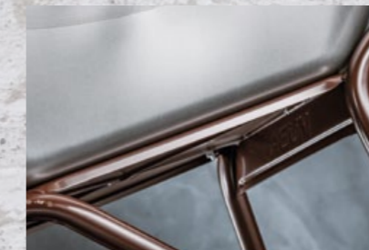
durchgehender Stahlblechboden unter der Mulde
